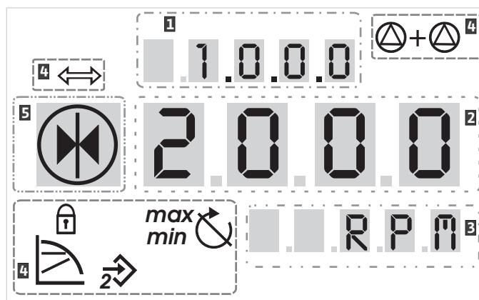
Рис. 27: Структура дисплея
