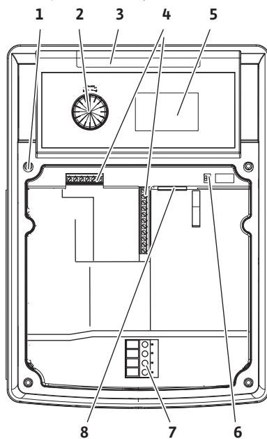
Рис. 9: Электронный модуль
