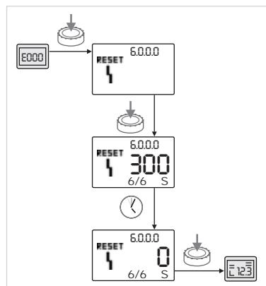
Рис. 48: Квитирование ошибки типа В
