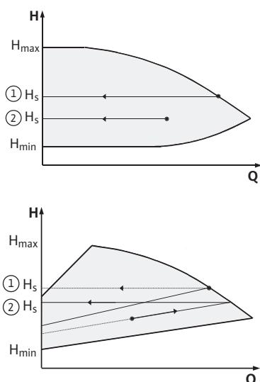
Rис. 40: Регулирование  $\Delta p-c/\Delta p-v$
