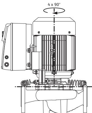
Рис. 19: Допустимые монтажные положения с вертикальным валом электродвигателя
