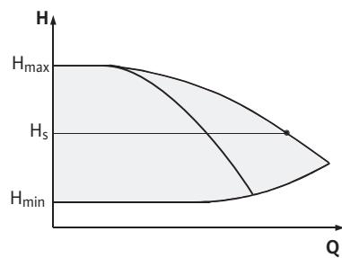
Рис. 14: Регулирование Др-с (режим совместной работы двух насосов)
