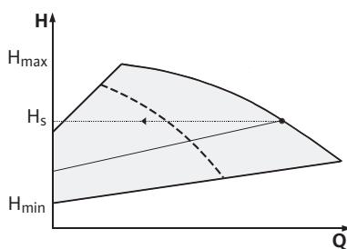
Рис. 15: Регулирование Др-в (режим совместной работы двух насосов)
