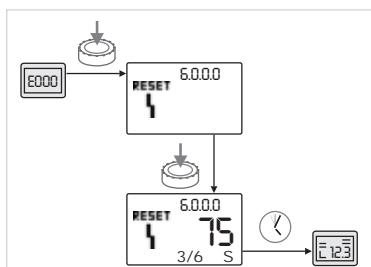
Рис. 47: Квитирование ошибки типа В ( $X < Y$ )
