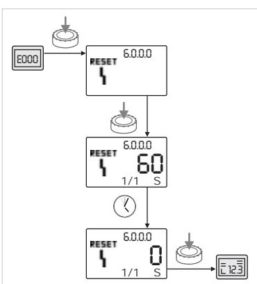
Рис. 45: Квитирование ошибки типа А или D
