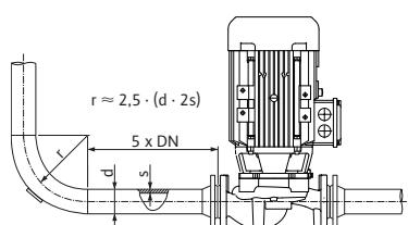
Рис. 21: Участок выравнивания потока перед и за насосом
